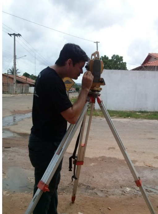
Figura 10: Levantamento topográfico com estação total.
