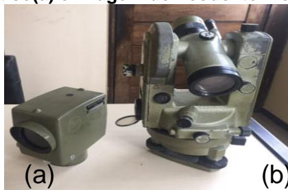
Figura 3: Nível ótico(a) e Imagem do Teodolito mecânico(b).
